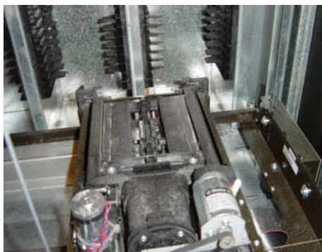
Blick in eine "HP Surestore Optical Jukebox" vor der Reinigung. Gut zu erkennen der „Baustaub“ durch Umbaumaßnahmen in der Nähe der Serverräume.
