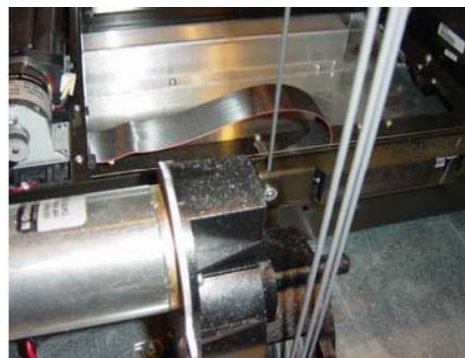
Blick in eine "HP Surestore Optical Jukebox" vor der Reinigung. Gut zu erkennen der „Baustaub“ durch Umbaumaßnahmen in der Nähe der Serverräume.
